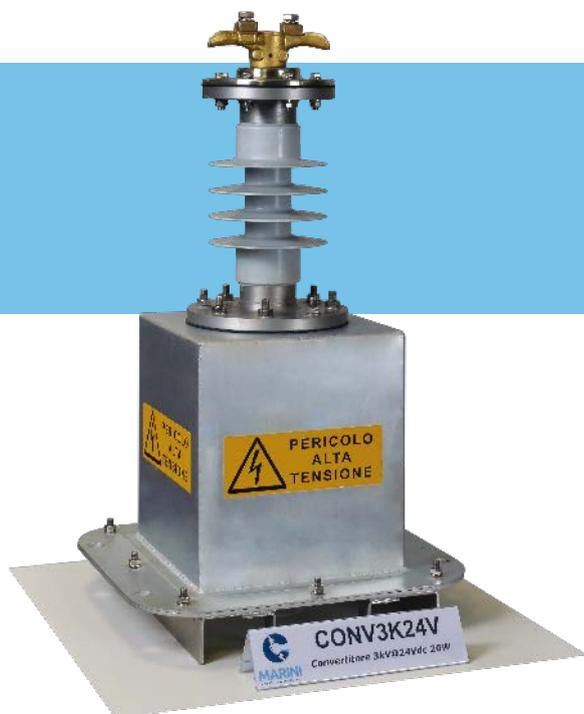
CONV3K24V – это преобразователь 20Вт DC / DC, предназначенный для генерирования непрерывного выходного на выходе 24В постоянного тока, начиная с напряжения контактной сети с номинальным значением 3 кВ постоянного тока.
