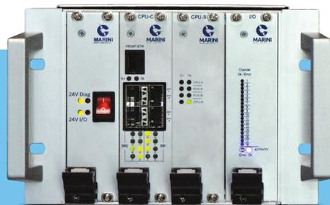
Il sistema per la Trasmissione Dati in Sicurezza (TDS) ha lo scopo di sostituire i cavi di relazione in rame tipicamente impiegati negli impianti di sicurezza e segnalamento. Il sistema TDS è costituito da insieme di apparati U-TDS, che comunicano tra loro con un protocollo sicuro PVS mediante una rete LAN.
