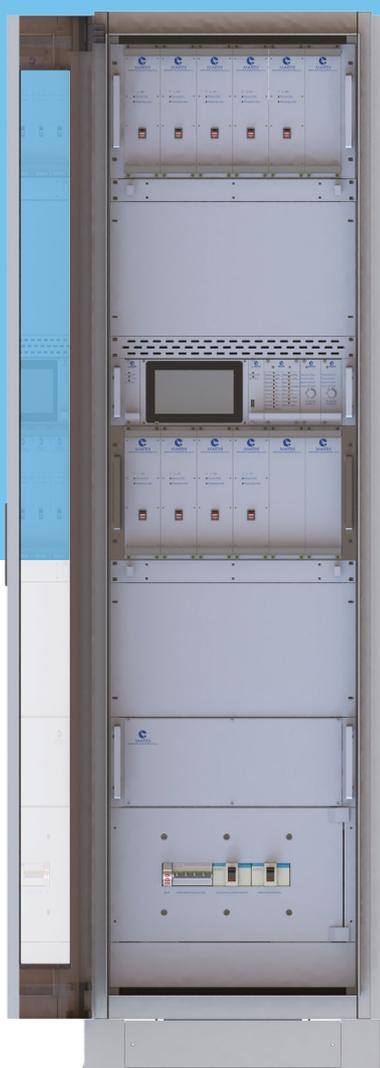
L'alimentatore stabilizzato carica batterie (ASC), in conformità alla specifica RFI IFS330A, è una stazione di energia in grado di generare una tensione continua ad uso dei servizi ausiliari previsti nelle Sottostazioni Elettriche (SSE) ferroviarie, garantendone la continuità di esercizio anche in caso di interruzioni della tensione di rete.
